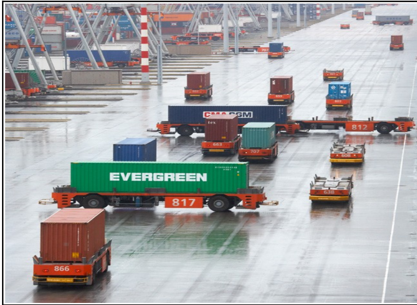
Plateforme automatisée de transfert de conteneurs Source : port Rotterdam
